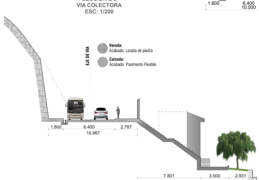
**AV LOS FRUTALES SECCIÓN 3-3 VIA COLECTORA ESC: 1/300**
